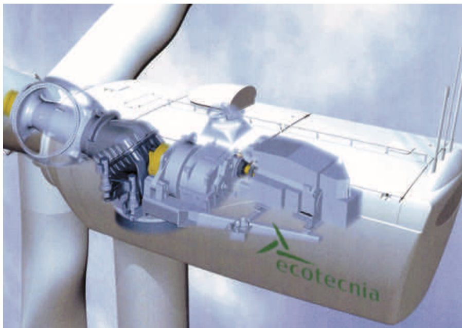
L'AEROGENERADOR «ECOTÈCNIA 80», DE 1.670 KW DE POTÈNCIA NOMINAL, HA ESTAT DISSENYAT PERQUÈ SIGUI APTA EN INDRETS AMB UNA MITJANA ANUAL DE VENT DE FINS A 7,5 M/S I UNA VELOCITAT DE RAÏEGA EXTREMA AMB UNA FREQUÈNCIA DE REPETICIÓ DE 50 ANYS DE 52,5 M/S.
